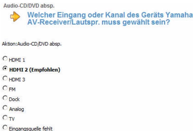
Der AV-Receiver, der sowohl als Signal-Eingangsverteiler als auch als Audio-Verstärker mit integrierten Lautsprechern fungiert, erhält bei dieser Aktion auf seinem **HDMI 2**-Eingang die Ton-Signale vom **DVD/Blu-ray Players** und gibt sie über seine Lautsprecher im **StereoMode** wieder.
