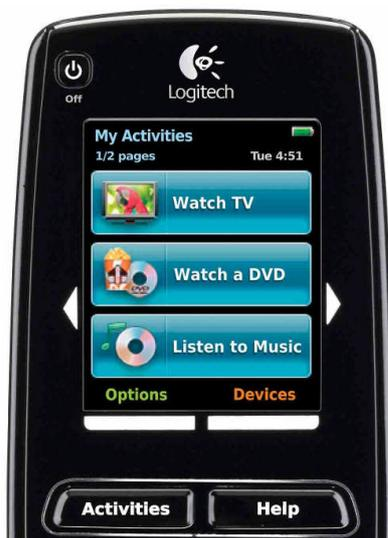
**Bild 27:** Touch-Screen-Display. In diesem Bild wird der **Grundzustand** mit den festgelegten **Eigenen Aktivitäten** (My Activities), den **Optionen** (Options) zur Einstellung der Fernbedienung und die Umschaltung auf die angeschlossenen **Geräte** (Devices) zur Auswahl angeboten.
