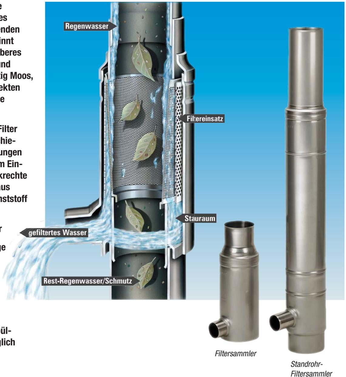
Gehäuse wahlweise aus Edelstahl, Zink oder Kupfer für die Nennweiten (DN) -100, -87, -80, -76. Auslaufstutzen DN 50. Filtereinsatz (Maschenweite wahlweise 0,28 oder 0,44 mm) aus Edelstahl, spülmaschinentauglich.
